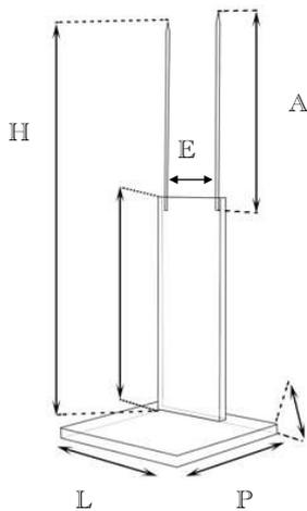
Le présentoir pour masques en bois est composé de trois parties : un support, une base en PMMA\* et deux tiges en inox pointues. Il est destiné à mettre en valeur des masques en bois dont la partie arrière est creuse.
