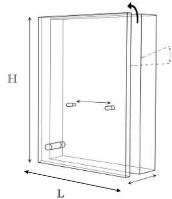
Ce modèle permet de présenter un objet plat seul, enserré entre deux plaques de PMMA\* pivotantes. Deux axes discrets maintiennent l'objet au centre du présentoir donnant une impression de flottement.
