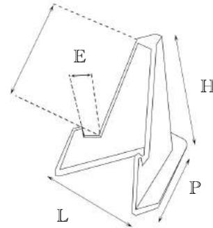
Ce présentoir monobloc en PMMA\* permet de disposer l'objet à la verticale avec une légère inclinaison vers l'arrière.
